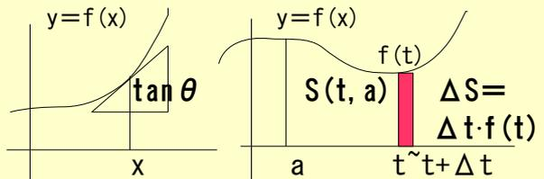
関数  $y = f(x)$  曲線グラフと  $x$  軸間の  $= [a, t]$  区間の面積  $S(t, a)$  が積分値。例として「時間変動する流量  $f(x)$  の過去  $a$  から現在  $t$  までの蓄積量」。
