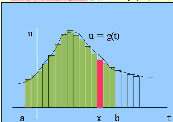
左図は関数  $u=g(t)$  を幅  $\Delta t$  の微小長方形で  $t$  の区間  $[a, b]$  と  $g$  曲線下面積  $S$  を極限近似。
